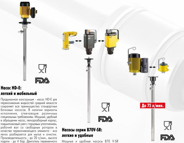
Мощные и удобные насосы B70 V-SR справятся и с текучими, и с высоковязкими жидкостями, в том числе и с небольшим содержанием твердых частиц. Привод - пневмодвигатель или электродвигатель переменного тока с напряжением 230 В, что обеспечивает удобную мобильную эксплуатацию. Производительность до 50 л/мин., а рабочее давление - до 6 бар.
