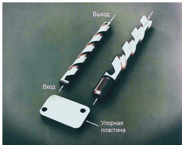
Фото 4. Гидравлический баланс ведомого винта однонаправленного типа
