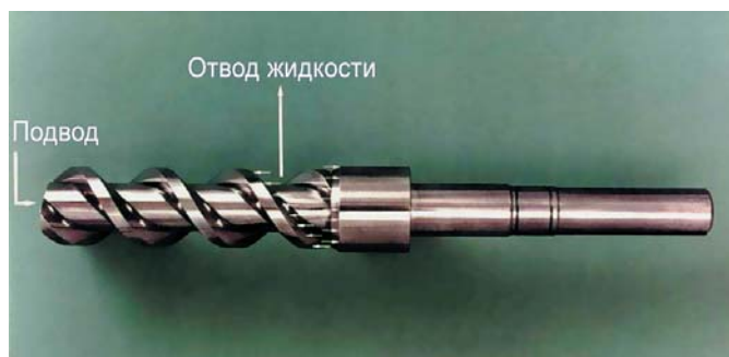
Фото 3. Гидравлический баланс на центральном роторе насоса одностороннего типа
